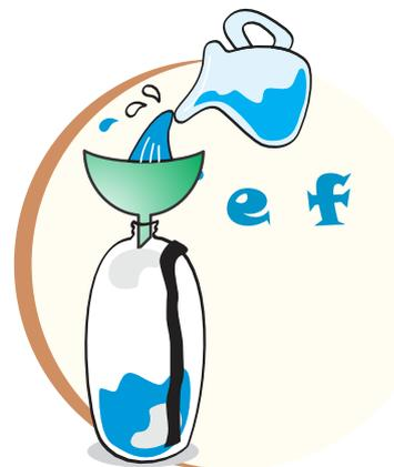
Esta atividade permite observar a variação de pressão com a profundidade. Quando a fita adesiva for retirada, a água começará a sair pelos furos. A distância alcançada pelos esguichos será variável com a profundidade - quanto mais próximo da base da garrafa, maior será o esguicho. Isso acontece, pois o peso da coluna de água é maior no fundo da garrafa do que na superfície. À medida que a garrafa esvazia e que a pressão hidrostática diminui, a distância alcançada pelos esguichos também reduz.
